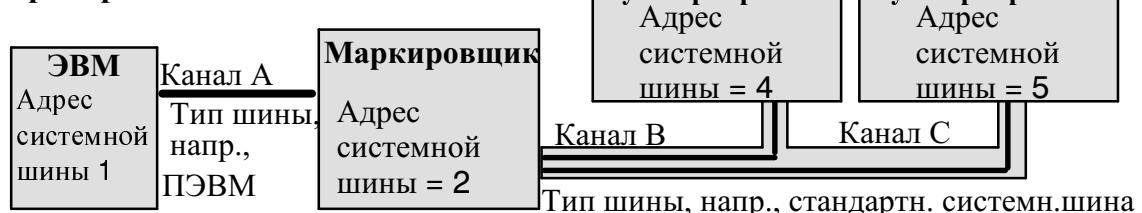
Для этого примера, настройки, как показано ниже в таблице параметров подключения, должны быть заданы на маркировочном аппарате (устройство **2**).
